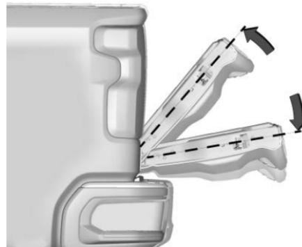
Para cerrar la puerta trasera usando la función de levantamiento para cerrar, levante la puerta trasera desde la posición completamente abierta a por lo menos 10 cm (4 pulg.) y sosténgala momentáneamente. Después, la puerta trasera comenzará a cerrar automáticamente. Si la puerta trasera se levanta a más de la mitad entre la abertura y cierre, entonces no se cerrará automáticamente.
