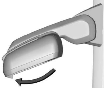
Si está equipado, sujete firmemente la carcasa del espejo y jale hacia atrás en un movimiento, arqueando ligeramente hacia la parte trasera del vehículo.
