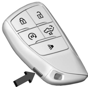
**(x2)** : Oprima y suelte **(🔒)**, después inmediatamente oprima sin soltar **(x2)** hasta que las luces direccionales parpadeen al menos por cuatro segundos. El motor puede arrancarse desde el exterior del vehículo utilizando la llave remota. Consulte *Arranque remoto* ⇨ 18.
