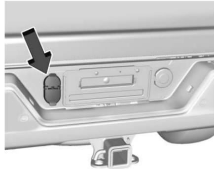
Si está equipado, el arnés de cableado del remolque, con un conector de siete clavijas y un conector de cuatro clavijas, está montado en la defensa trasera del vehículo.
