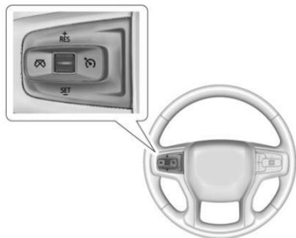
: Presione para encender o apagar el control de velocidad constante. Una luz indicadora de color blanco se enciende en el tablero de instrumentos cuando el control de velocidad constante está encendido. Consulte *Luz de control de velocidad constante* ⇨ 139.
