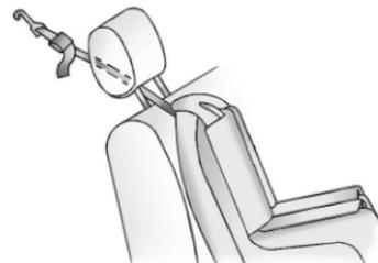
Si la posición que está utilizando tiene una cabecera ajustable y está utilizando sólo una atadura, levante la cabecera y pase la correa por debajo de la cabecera así como entre las barras de la cabecera.
