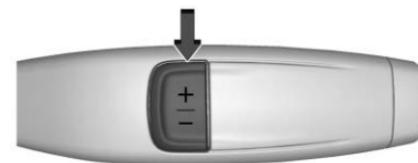
El Modo de selección de rango ayuda a controlar la transmisión del vehículo y la velocidad del vehículo mientras conduce
