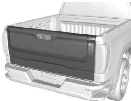
Los interruptores en la puerta trasera interna previenen que la puerta trasera principal se abra cuando la puerta trasera interna no está cerrada completamente.
