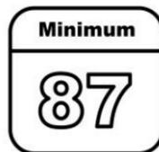
Si el vehículo tiene una calcomanía amarilla en la puerta de combustible, se puede usar E85 o FlexFuel. Si el vehículo no tiene una calcomanía amarilla, no use gasolina con niveles de etanol superiores al 15% por volumen. Consulte *E85 o FlexFuel (Sólo motor de 5.3L compatible con E85)* ⇨ 338.
