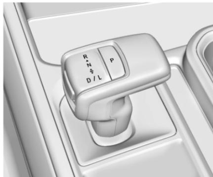
El patrón de cambios se muestra en la parte superior de la palanca de cambios. La posición de velocidad seleccionada se ilumina en rojo en la palanca de cambios, mientras que todas las demás se proyectarán en blanco. Si el cambio no es inmediato, como en condiciones muy frías, el indicador en el interruptor de cambios puede parpadear hasta que esté completamente conectado.
