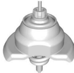
Incline el retenedor y tire de él a través del centro de la rueda, junto con el cable y el resorte.
