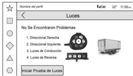
Esta vista muestra los nombres de las clavijas del conector del remolque, una gráfica del conector del remolque y una gráfica de la parte posterior del remolque.
