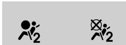
Los símbolos del indicador de estado de la bolsa de aire del pasajero se iluminarán por varios segundos como una verificación del sistema. Entonces, después de varios segundos más, el indicador de estado se iluminará para indicar el estado de la bolsa de aire delantera del pasajero externo delantero. Vea *Indicador de estado de bolsa de aire del pasajero* ⇨ 129.
