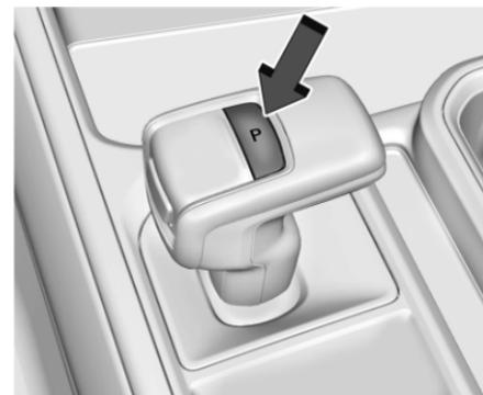
**P:** Esta posición bloquea las llantas traseras. Use P (Estacionamiento) cuando arranque el motor para evitar que el vehículo se mueva fácilmente.
