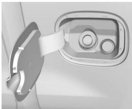
El sistema de relleno de combustible sin tapa no tiene una tapa de combustible. Inserte completamente y asegure la boquilla de relleno, durante el reabastecimiento.
