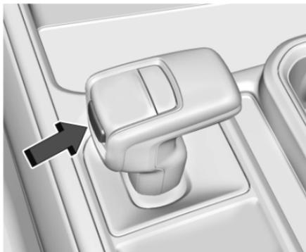
Este vehículo está equipado con transmisión controlada electrónicamente. El botón de liberación de bloqueo de cambios está diseñado para evitar que se cambie inesperadamente fuera de P (Estacionamiento) excepto que la ignición esté encendida, el pedal del freno esté aplicado, y se oprima el botón de liberación de bloqueo de cambios.
