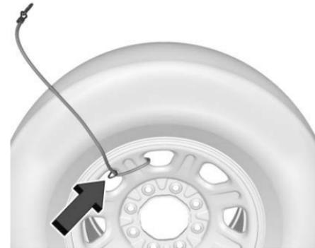
1. Si está equipado con un cable de llanta de refacción, vuelva a instalar el cable en la rueda de refacción enrollando el cable alrededor de la ventana de ventilación de la rueda y luego pase el extremo del broche del cable a través del extremo enrollado. El cable sobrante debe estar en el lado del vástago de la válvula de la llanta de refacción.
