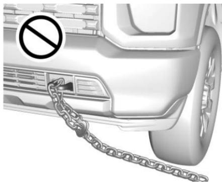
Si el vehículo tiene ganchos de recuperación en la parte delantera, úselos si el vehículo está atascado fuera de la carretera y necesita ser jalado en algún lugar para seguir conduciendo.
