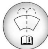
Abra el tapón que tiene el símbolo del lavaparabrisas. Agregue líquido para lavaparabrisas hasta llenar el tanque. Vea en *Vista general del compartimento del motor* ⇨ 384 la ubicación del depósito.
