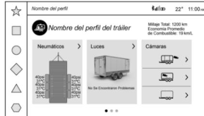
Si hay un remolque conectado, la vista de Estado muestra información de estado para el perfil de remolque activo.
