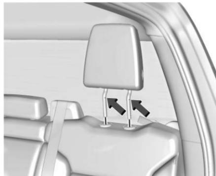
1. Inserte los postes de la cabecera o apoyacabezas en los orificios que se encuentran en la parte superior del respaldo. Las muescas de los postes deben mirar hacia el lado del conductor del vehículo.
