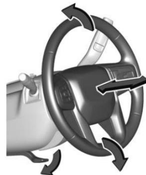
Para ajustar el volante de inclinación y telescópico, si está equipado:
