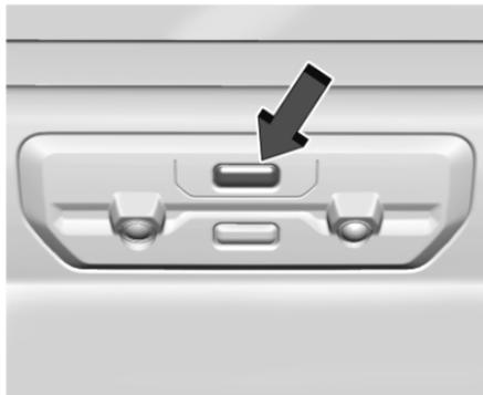
La puerta trasera interior MultiFlex puede estar equipada con una función de activación/desactivación para prevenir que la puerta trasera interior se abra cuando se instale un gancho u otro equipo que podría dañar la puerta trasera interior.
