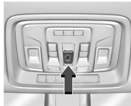
Si está equipado, la ventana trasera eléctrica funciona cuando la ignición está encendida o en modo de accesorios, o la Energía retenida para los accesorios (RAP) debe estar activa. Consulte *Energía retenida para los accesorios (RAP)* ⇨ 242.
