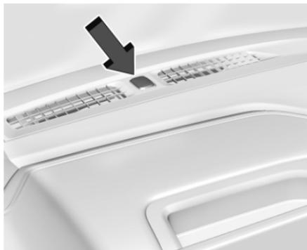
El sensor solar, arriba del tablero de instrumentos junto al parabrisas, monitorea el calor solar.
