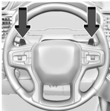
La Selección electrónica de rango (ERS), o Modo manual, permite la selección del rango de posiciones de las velocidades. Utilice este modo al conducir en una pendiente hacia abajo o al
